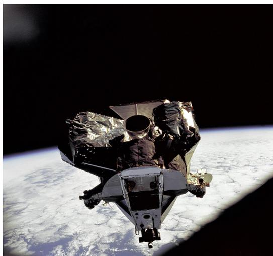
*Das LM, mit ausgeklappten Landebeinen und abgetrennt vom Mutterschiff. Die langen „Antennen“ an den Beinen zeigen dem Piloten den Bodenkontakt am Mond an.*
