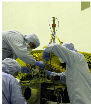
*New Horizon beim Zusammenbau. Knapp 500 kg wiegt die Sonde, eigentlich ein Leichtgewicht im Vergleich zu ihren „Kollegen“.*
